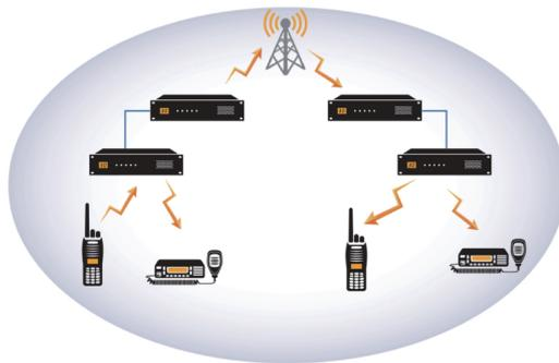
NEXEDGE® 的中转台具有无线联网功能，将两台中转台连接起来，形成一组中转台-链路台。不需要IP网支持，能够在没有IP资源的情况下，实现多基站联网。
